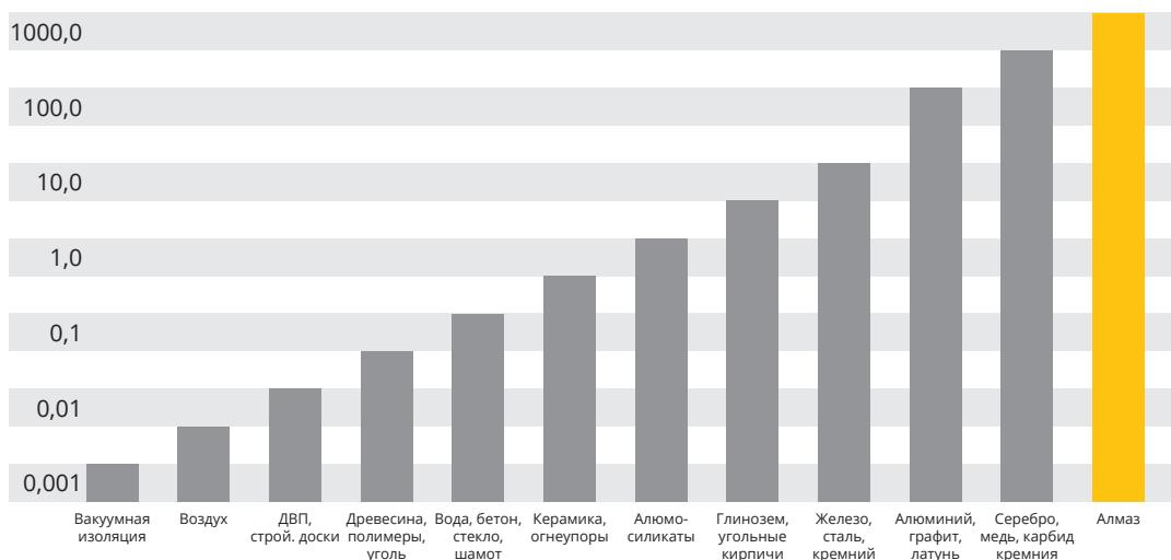
Перечисленные механические и термические свойства определили область использования алмаза как уникального материала в обработке материалов резанием. Ни один из известных материалов в природе, в сравнении с алмазом, не способен так эффективно внедряться в обрабатываемый материал, скользить по поверхности, не образуя лишнее тепло.
