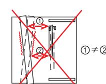
Никогда не работайте без фиксации направляющей рейки и без контроля параллельности направляющей рейки к плоскости диска.
