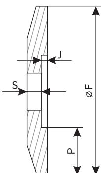
Срок службы корпуса диска зависит не только от режимов резания, но и от точности настройки оборудования, состояния опорного и прижимного фланцев.
