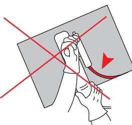
Не используйте отрезной диск для криволинейной резки.
