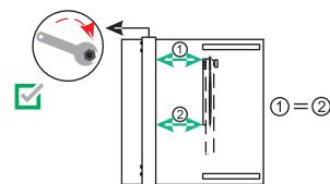
Убедитесь, что направляющая рейка установлена параллельно диску и зафиксирована.
