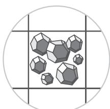
Этот показатель характеризует количественное содержание алмазов в инструменте. При 100% относительной концентрации алмазы занимают 1/4 часть объема алмазоносного слоя инструмента. При этом на 1 см<sup>3</sup> алмазоносного слоя приходится 4,4 карата алмазов (1 карат = 0,2 грамма).
