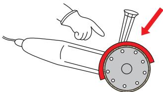
Работайте только с защитным кожухом.
