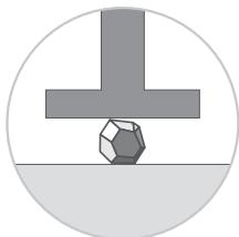
Прочность синтетических алмазов на сжатие (статическая прочность) определяется нагрузкой, при которой разрушается единичный кристалл. По стандартам СНГ, обозначение алмазного порошка включает в себя среднее значение показателя прочности для данной марки алмазов. Импортные производители имеют другие системы обозначений но, как правило, чем выше число, тем прочнее алмаз.
